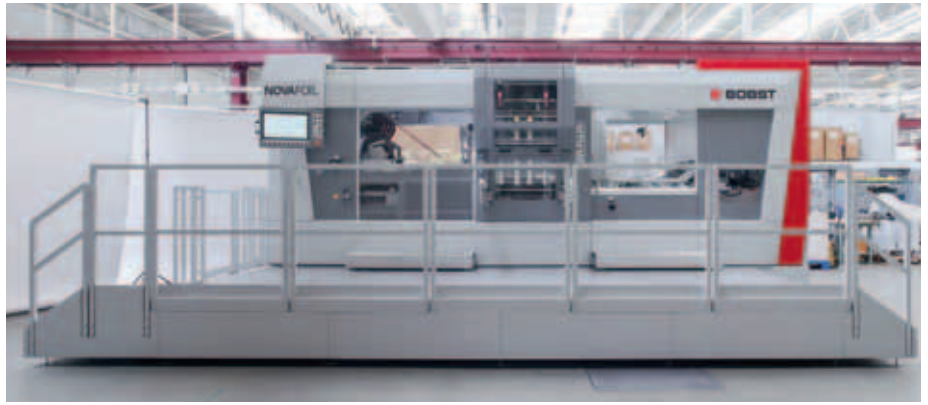
NOVAFOIL 106 je Bobstov prvi stroj za aplikacijo vroče folije v prečni in vzdolžni smeri teka papirja.
