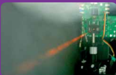
Slika 2: Demonstracija oddajanja – emitiranja 40-kanalnega VCSEL-modula (Laserski žarek, viden s pomočjo bele meglice).
