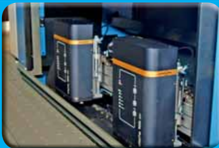
Nove integrirane kapljične izpisne glave Delta 105i-UV.
