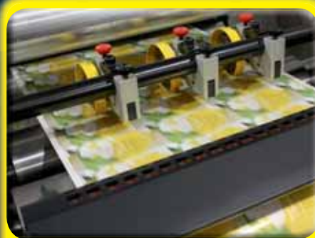
Nov sistem tiska etiket izpisuje tudi z belo pokrivno barvo.
