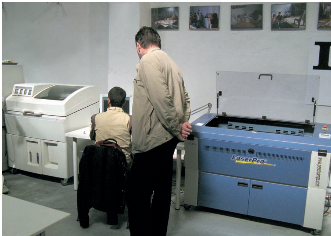
Laboratorij za praktično usposabljanje 3D-tiskanja v inštitutu Iaac. Slika zgoraj prikazuje tridimenzionalne izdelke, ki so jih natisnili s tiskalnikom na levi strani spodnje slike. »Klišegraf« LaserPro gravira ali reže zelene strukture na navaden papir.
