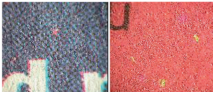
Slika 2b. Neustrezna kakovost odtisa – dobro so vidne površine, ki niso potiskane s tiskarsko barvo (mikroskopski posnetek – povečava 20x).
