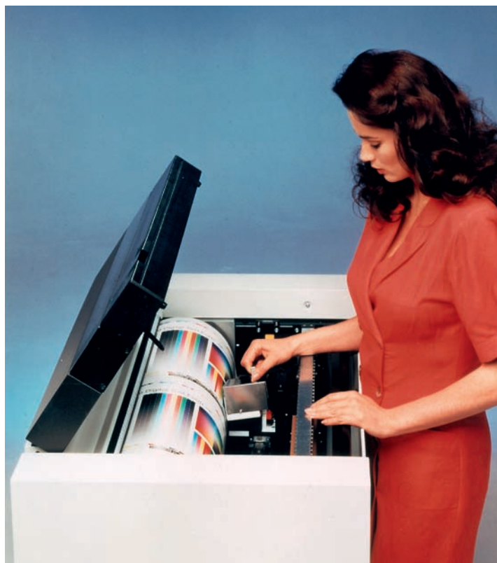
Slika 33. Studiojski tiskarski stroj za kapljični tisk s tiskovno glavo ob tiskovnem valju, na katerega je napet tiskovni material.
