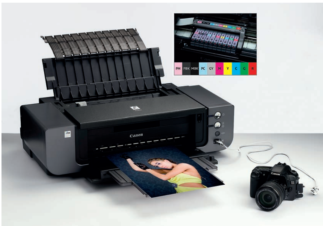
Slika 31. Fotokapljični tiskalnik za avtorsko ali studijsko uporabo ima v tiskovni glavi šest ločenih kartuš za tiskarska črnila C1 + C2 + M1 + M2 + Y + K. Nekateri imajo namesto dveh pisanih barv dve črni (sivi), da lepše natisnejo črno-bele slike, drugi tudi do deset kartuš s procesnimi barvami. Tiskovna glava upodablja sliko v obeh smereh ( bi-directional ), tiskovni material pa se giblje pod njo enosmerno. Tiskalniki te vrste uporabljajo tiskarska črnila na podlagi barvil ali pigmentov. Pigmentna so svetlobno bolj obstojna, barvila pa ponujajo več možnosti pri tiskanju različnih materialov (folije, tekstil, preslikači ipd.).
