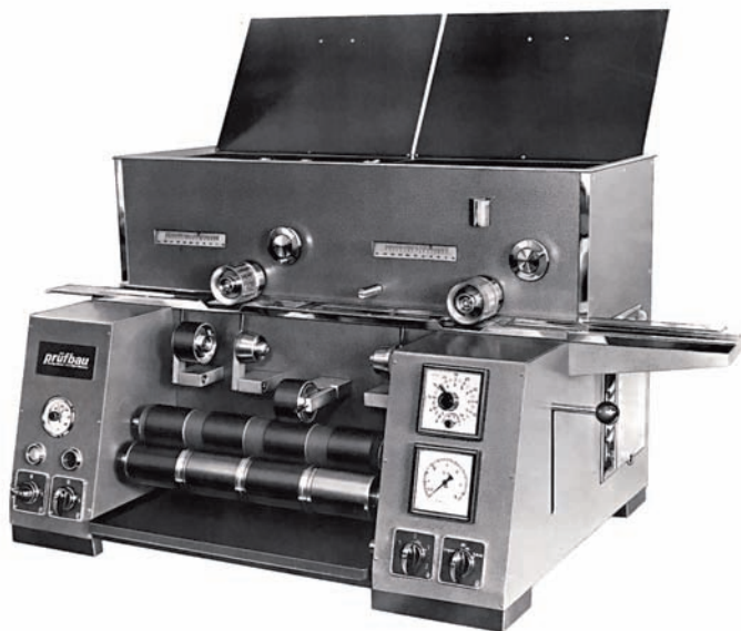
Slika 3. Naprava za izdelavo laboratorijskega odtisa Prüfbau-Dürner.
