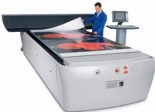
Slika 36. Nekateri stroji za velikoformatni kapljični tisk spominjajo na ofsetne odtisovalnice, saj imajo tiskovne glave nameščene v gibajočem se vozičku, medtem ko tiskovni material miruje na tiskovni plošči.
