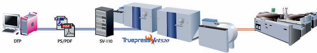
Slika 41. Dainippon Screenova rotacija za tiskanje časopisov v kapljičnem tisku je vsekakor enoprehodni sistem. Za obojstranski tisk vključuje dva podobna tiskovna člena.
