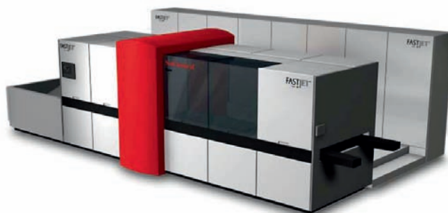
Slika 40. Tiskarske barve za enoprehodni kapljični stroj Inca FastJet proizvaja SunChemical, ki ga tudi trži. Namenjen je za tiskanje embalaže iz valovitih kartonov in naj bi izpodrinil fleksotiskarske stroje.
