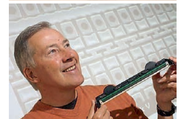
Slika 45. Stacionarna tiskovna letev s tiskovnimi glavami in kartušami MEMJET.
