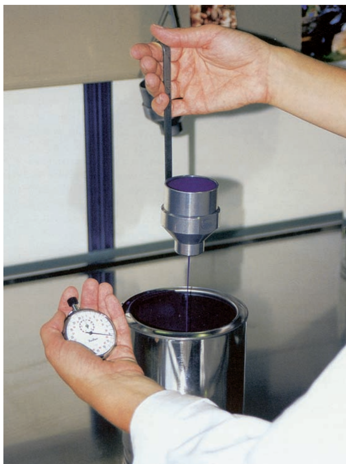
Slika 38. Merjenje viskoznosti fleksotiskarske barve.
