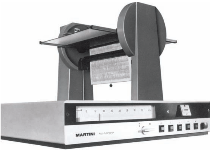
Slika 6. Aparat za dinamično preskušanje zlepljenosti KB Müller Martini, tip VA.
