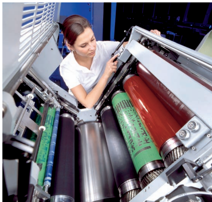
Rapida 105, paradni konj najstarejše tovarne tiskarskih strojev na svetu KBA – Koenig & Bauer AG s sedežem v Würzburgu, Nemčija. Svoja podjetja imajo po vsem svetu, tudi na Češkem, kjer so razvili ofsetni stroj Performa 74; slika spodaj. Na desni sliki je odprt tiskovni člen digitaliziranega ofsetnega stroja Genius 52. Lepo sta vidni dve že upodobljeni tiskovni formi.
