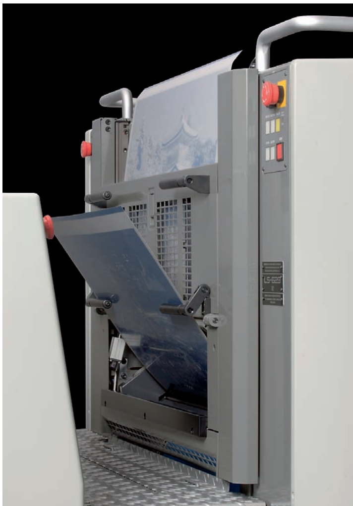
Slika 10. Na novo razviti izmenjevalnik tiskovnih form ima vsak tiskovni člen ofsetnega stroja Komori Lithrone LS29. Zamenjava štirih form traja dve minuti in pol in zagotavlja minimalna odstopanja barvnega skladija.
