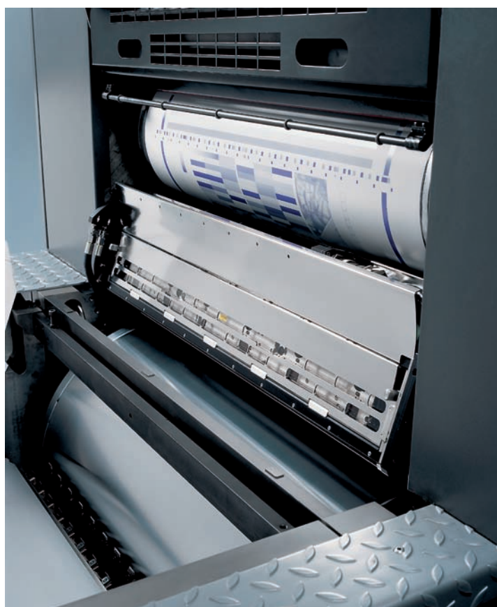
Integrirani kolorimeter Inpress Control meri odtise v stroju namesto na nadzorni mizi. Prihrani najmanj čas za odvzem vzorčnih odtisov.
