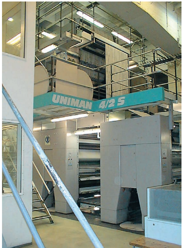
Ofsetna rotacija MAN Uniman 4/2 z »Y« zasnovi tiskovnih členov je časopis Delo tiskala v barvah slabih deset let – od oktobra 1994 do maja 2004. Življenjska doba takih strojev je bila nekdanj trideset let in več, četudi tehnično v dobrem stanju pa sedaj tehnološko zastarajo bistveno hitreje.
