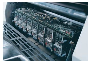
Upodobitvena glava na strojih AFAST DI, zunaj stroja in v tiskovnem členu ob ploščnem valju.
