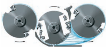
Slika 6. Obračalni bobni ima dvojni premer tiskovnih valjev.
