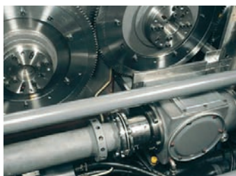
Slika 4. Dvojni pogon z zobčniki in longitudinalno osjo.
